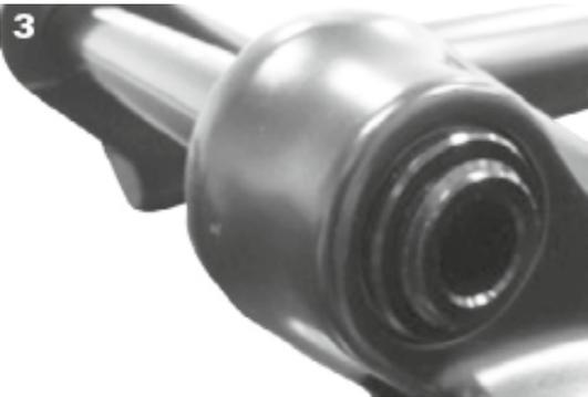
3. Überprüfen Sie das Gewinde der Achse. Es muss sichtbar sein.
