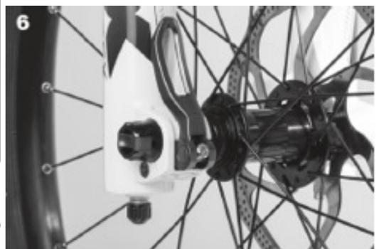
6. Der Hebel muss bündig am Tauchrohr anliegen.
