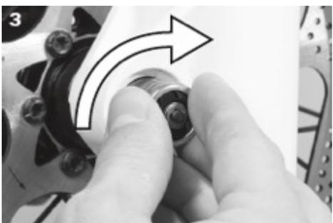
3. Einstellmutter im Uhrzeigersinn drehen, bis der Flansch eingerastet bleibt.
