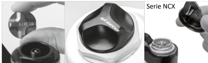
1. Schrauben Sie die Ventilkappe ab. Schrauben Sie eine Gabel-/Dämpferpumpe auf das Ventil.
