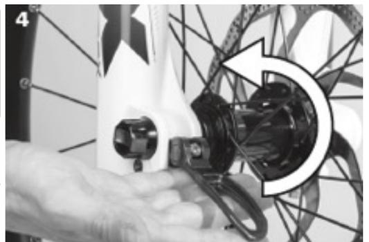
4. Schließen Sie den Schnellspannhebel.
