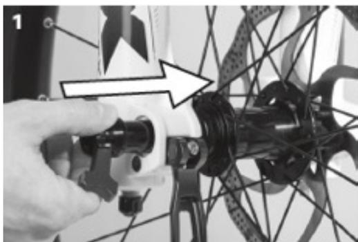
1. Schieben Sie die Achse auf der Schnellspannhebel-Seite hinein.
