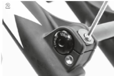
2. Ziehen Sie die Sicherungsklemme mit einem 4mm Innensechskantschlüssel auf 7Nm an.
