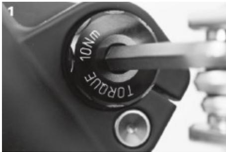
1. Schieben Sie die Achse hinein und ziehen Sie sie mit einem 6mm Innensechskantschlüssel auf 10Nm an.
