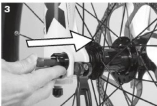
3. Nun ist es möglich, den Hebel in die Achse hineinzuschieben.
